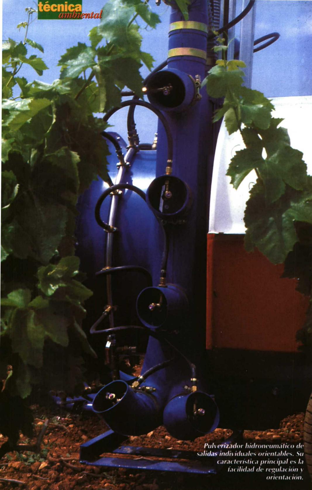
*Pulverizador hidroneumático de salidas individuales orientables. Su característica principal es la facilidad de regulación y orientación.*
