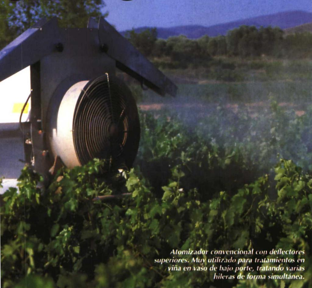
*Atomizador convencional con deflectores superiores. Muy utilizado para tratamientos en viña en vaso de bajo porte, tratando varias hileras de forma simultánea.*
