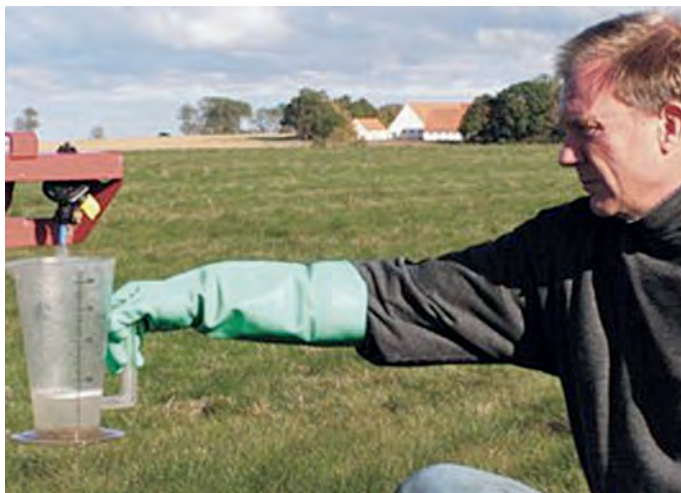
FOTO 3. Es necesario vigilar el estado de las boquillas ya que sufren un desgaste por abrasión al pasar el líquido a presión a través de ellas
