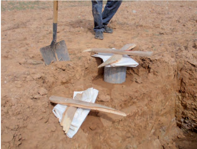
Estudio de la velocidad de infiltración en el suelo. Los cilindros de infiltración se clavan en el suelo para medir la velocidad de infiltración del agua en los distintos horizontes del perfil del suelo.
