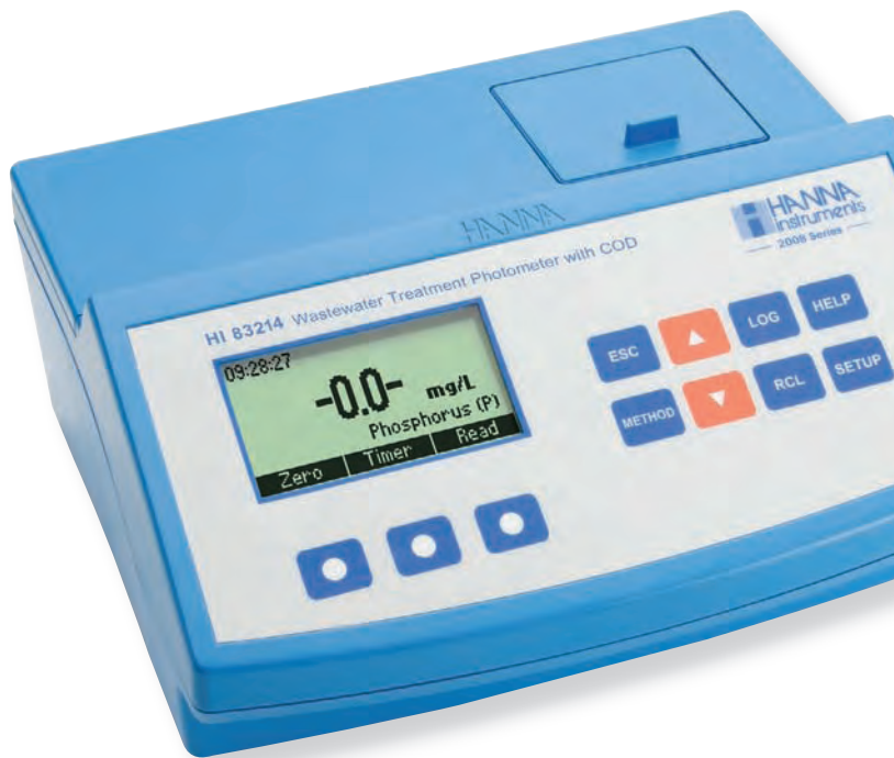
Foto 1. Fotómetro multiparamétrico HANNA Instruments (HI 83214) utilizado para la determinación de nitrato (NO3-) en los extractos de saturación obtenidos a partir de muestras de suelo. Análisis comparativos realizados en el Departamento de Producción Vegetal: Fitotecnia de la Escuela Técnica Superior de Ingenieros Agrónomos de la Universidad Politécnica de Madrid (UPM).
