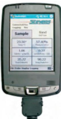
Software para la comunicación desde un dispositivo móvil con la sonda de suelo
