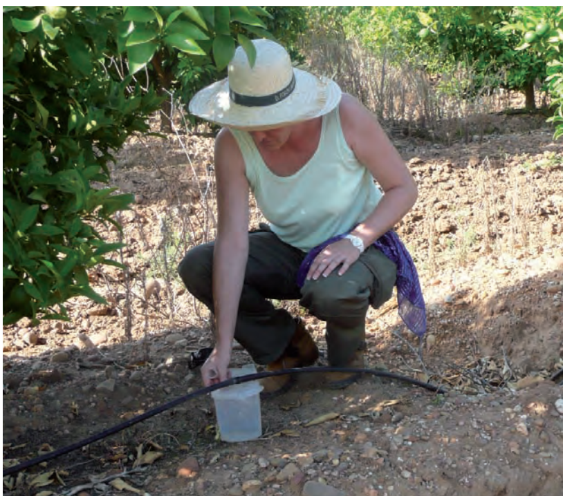
Foto 2. Medida del caudal suministrado por un emisor para una evaluación de riego localizado.
