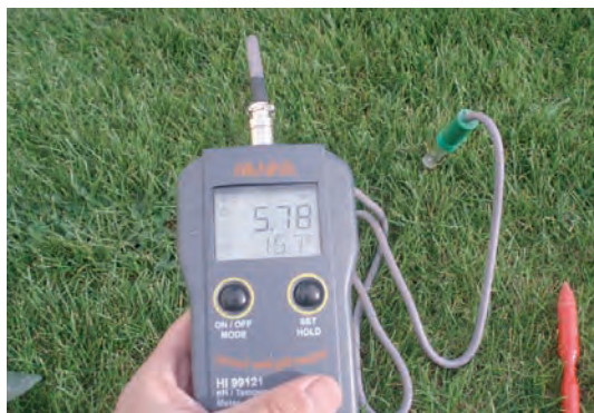
Foto 1. pHmetro portátil Hanna HI99121 para medir pH directamente en suelos y sustratos
