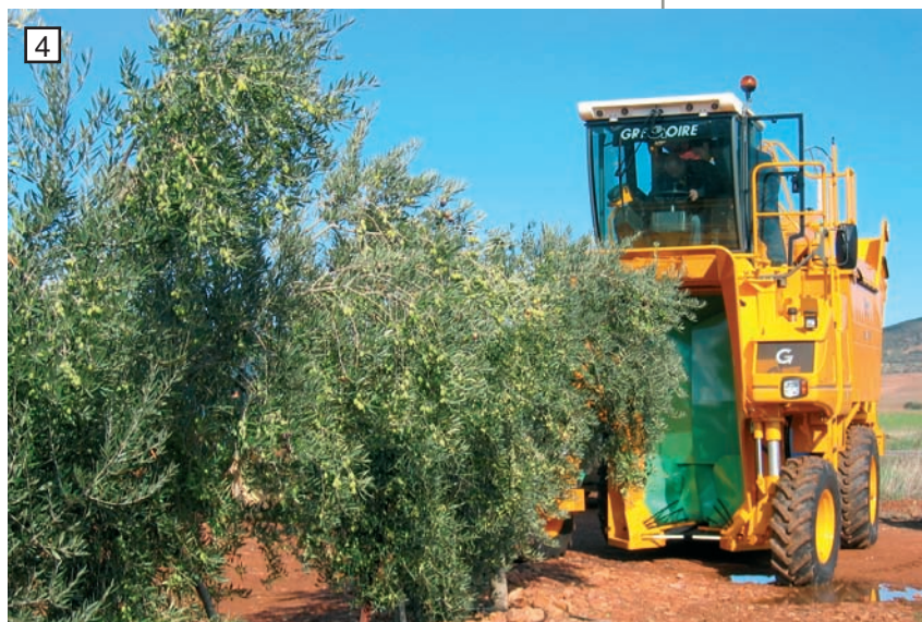
Figura 4. Máquina recolectora tipo cabalgante utilizada en la recogida de aceitunas de una plantación en seto
