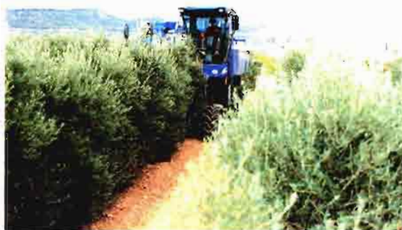
Modelo VX680 de la cosechadora de New Holland que puede trabajar tanto en vendimia como en olivar superintensivo, tal y como se aprecia en esta imagen
