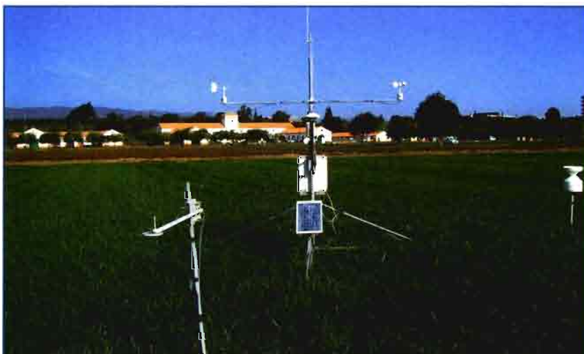
Estación meteorológica automática empleada para el cálculo de la evapotranspiración de referencia (ETo), dato imprescindible en la programación de riegos. Está provista de radiómetro, sensor de temperaturas y humedad relativa, pluviómetro y anemómetro
