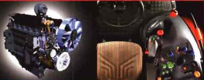
**SAME IRON:** el nuevo motor Deutz Euro II, la transmisión Powershift y la instalación hidráulica Load Sensing (opc.), sintetizan desde los trabajos más exigentes al transporte veloz.
