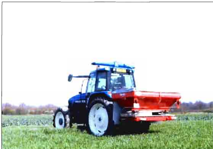
Detalle de funcionamiento de un equipo N-Sensor para abonado en cobertera.
