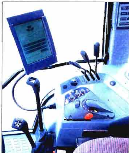
Detalle del terminal DATAVISION II instalado en una cosechadora Massey Ferguson (izquierda) de donde se extrae la tarjeta con los datos (centro) que se utiliza para transportarla a un ordenador de la explotación y posteriormente al terminal de un tractor Massey Ferguson (derecha)
