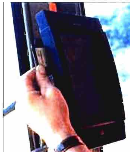
Detalle del terminal DATAVISION II instalado en una cosechadora Massey Ferguson (izquierda) de donde se extrae la tarjeta con los datos (centro) que se utiliza para transportarla a un ordenador de la explotación y posteriormente al terminal de un tractor Massey Ferguson (derecha)
