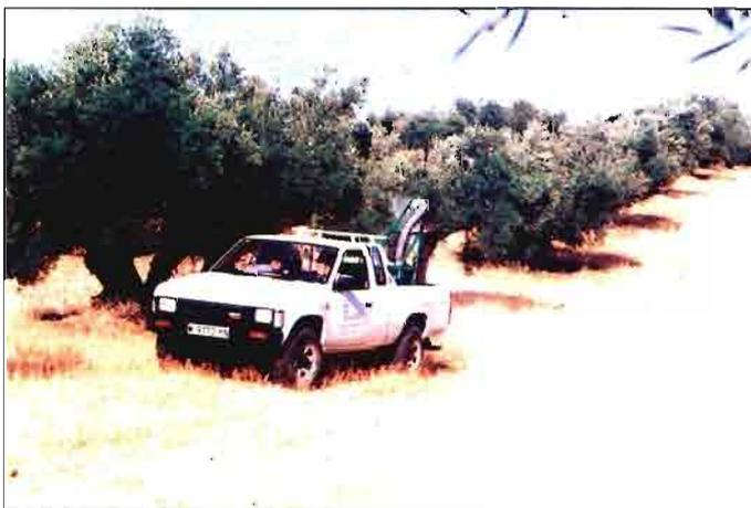
Atomizador Micronair AU 8115 montado sobre Nissan Pick-up Todo Terreno tratando olivos con la Técnica ULV.
