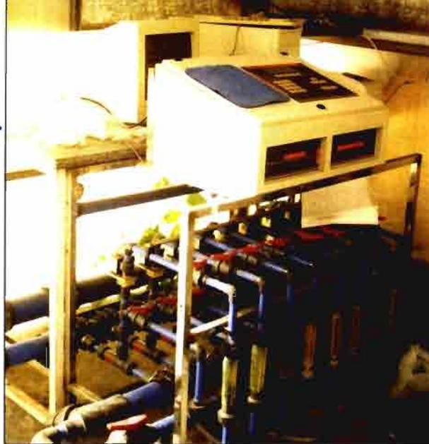
Equipo automatizado para fertirrigación en riego por goteo
