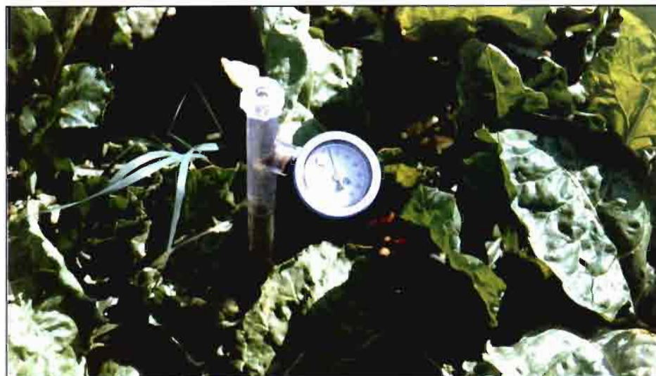
Tensiómetro para controlar el nivel de humedad del suelo
