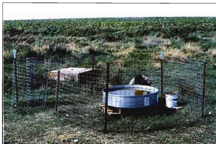
Cubeta evaporimétrica para el seguimiento de las necesidades de agua de los cultivos
