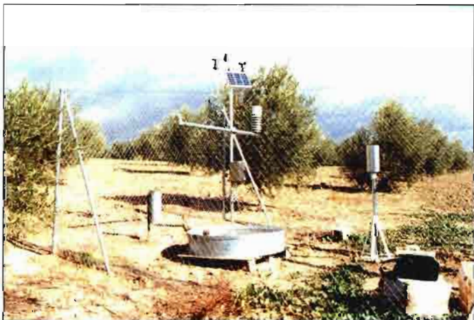
Estación meteorológica automática empleada por el Servicio de Asesoramiento al Regante para la programación del riego. Mensualmente se han suministrado datos sobre los valores estimados de la evapotranspiración de referencia (E 0 ), parámetro cuyo conocimiento es indispensable para el cálculo de las necesidades de agua
