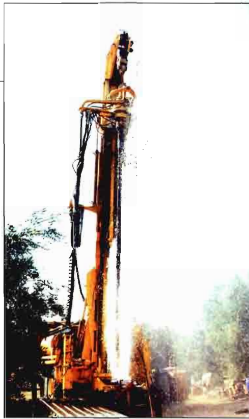
Para el riego del olivar en ocasiones se han buscado recursos de agua en el subsuelo, siendo frecuentes los sondeos a más de 300 m de profundidad. Máquina de rotoperforación en el momento del alumbramiento del agua
