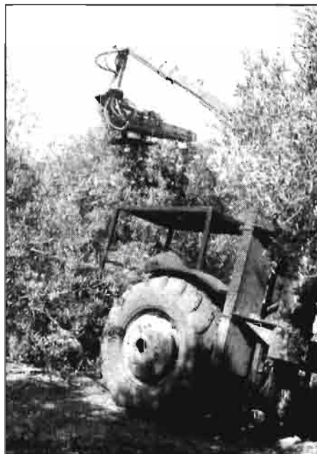
Podadora mecánica aplicada a olivar intensivo.
