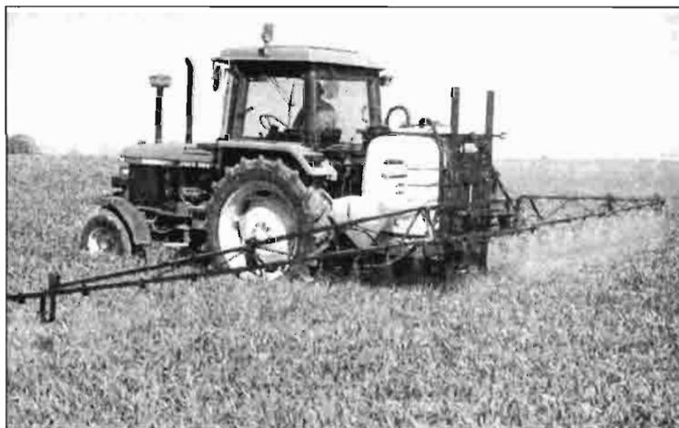
*Pulverizador hidráulico suspendido.*
