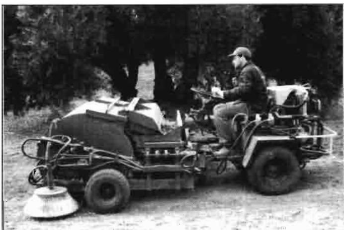
Máquina recogedora de frutos del suelo, dotada de cilindro recogedor que gira en sentido contrario al avance. Demostración de Recolección Mecanizada de Aceitunas. Archidona (Málaga), 1993.
