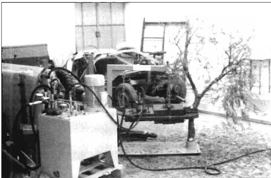
**Figura 7:** Ensayo de circuitos de hidrostáticos.
