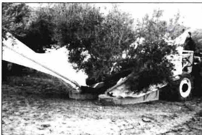
Sistema de vibrador-paraguas invertido, considerado casi como una cosechadora integral.
