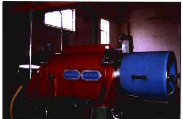
La mayor parte de las empresas fabricantes de sistemas continuos disponen de modelos de centrifugas horizontales de dos fases.
