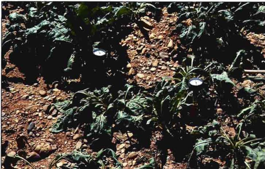
Tensiómetros colocados a 30 y 60 cm de profundidad.
