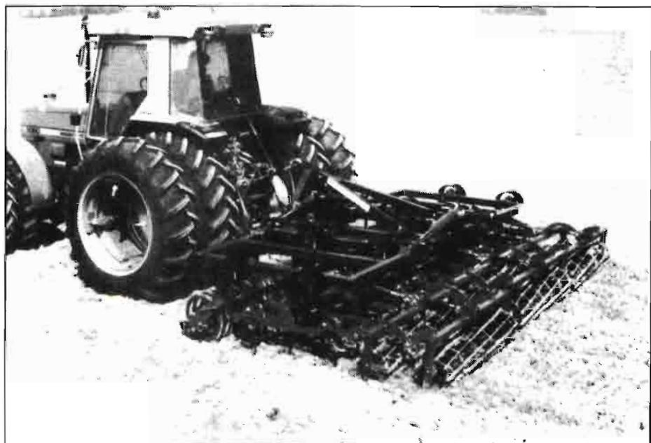
Maestro es una nueva herramienta, para la preparación de la tierra para la siembra, destinado a grandes extensiones y a un trabajo intensivo, que trabaja a alta velocidad (10 a 12 km/hora).
