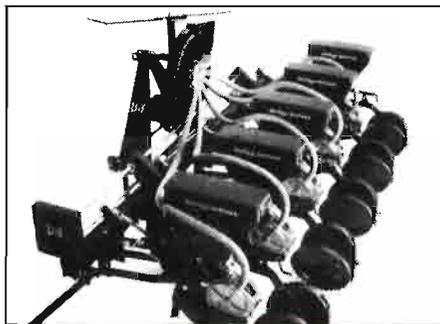
*La sembradora neumática de precisión "Lelysem" es modulable a partir de 0,26 m para toda clase de ancho y semilla y viene empleándose en la siembra de soja, colza, maíz y girasol.*
