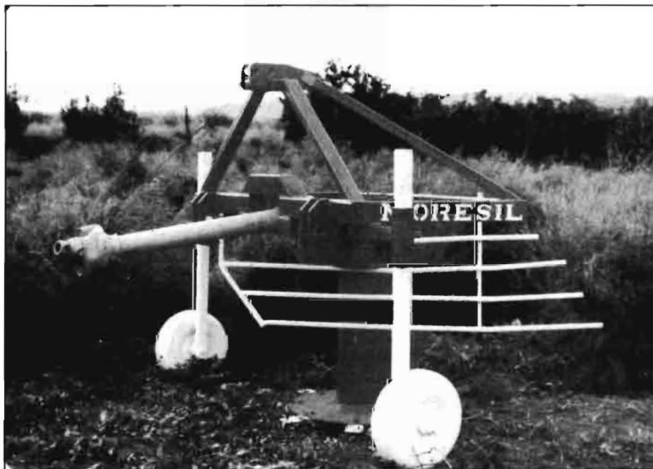
— Cortadora de matas de espárragos Moresil (suspendida al hidráulico del tractor).
