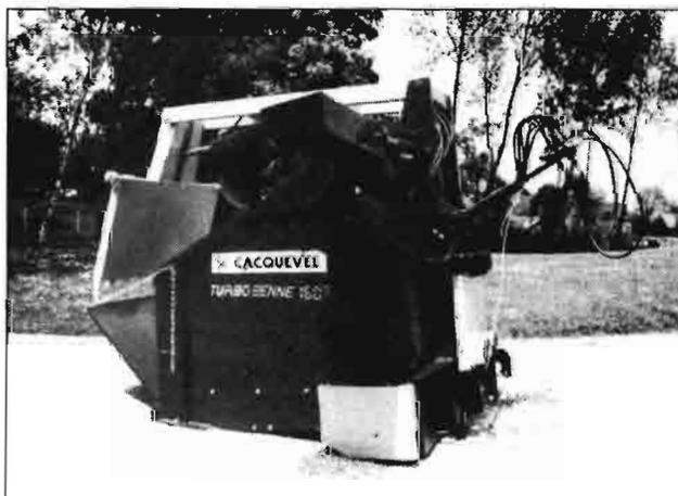
*Cacquevel presenta su modelo "Turbobenne 1607 D", una desensiladora, distribuidora y empacadora, que permite cargar en un silo maíz o hierba, distribuirlos en los comederos y extender la paja en la zona de descanso de las vacas.*
