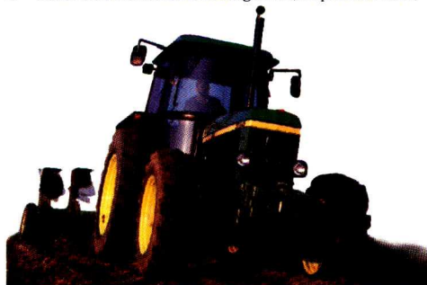
Tractor 2850 de 4 cilindros, prueba OECD 1021 A = Potencia constante entre 2000 y 2300 r/min. B = Incremento del par: 20,9% C = Consumo de combustible: 223 g/kWh (a la potencia máx.)
