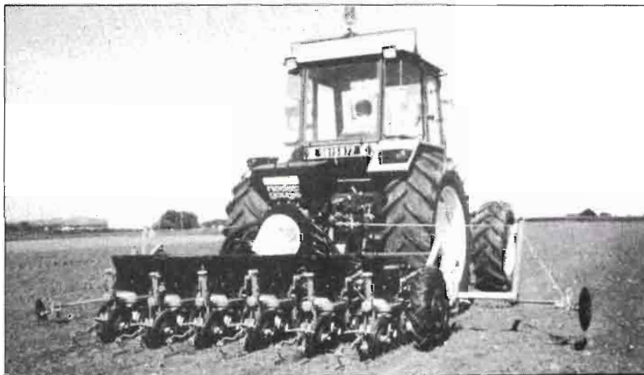
Después de finalizado el verano la implantación del cultivo debe hacerse con una sembradora monosurco adaptada a las características de la semilla.
