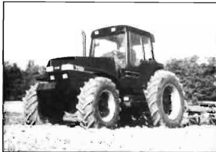
— Transmisión totalmente hidráulica. 24 velocidades de avance (18 standard + 6 supercortas) más 4 de retroceso.
