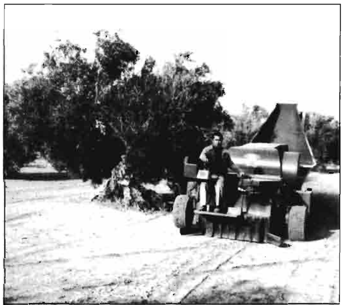
Ensayos de recogida mecanizada de aceitunas del suelo.
