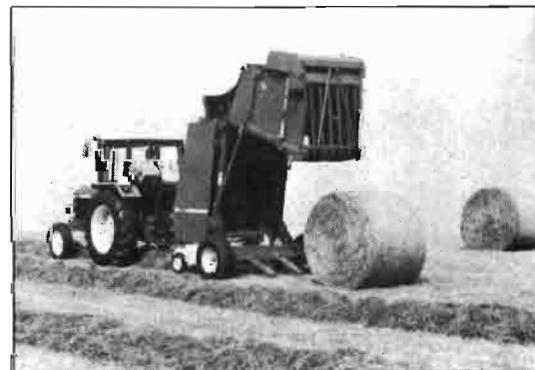
Rotoempacadora John Deere, mod. 550, con sistema de atado de pacas con red.
