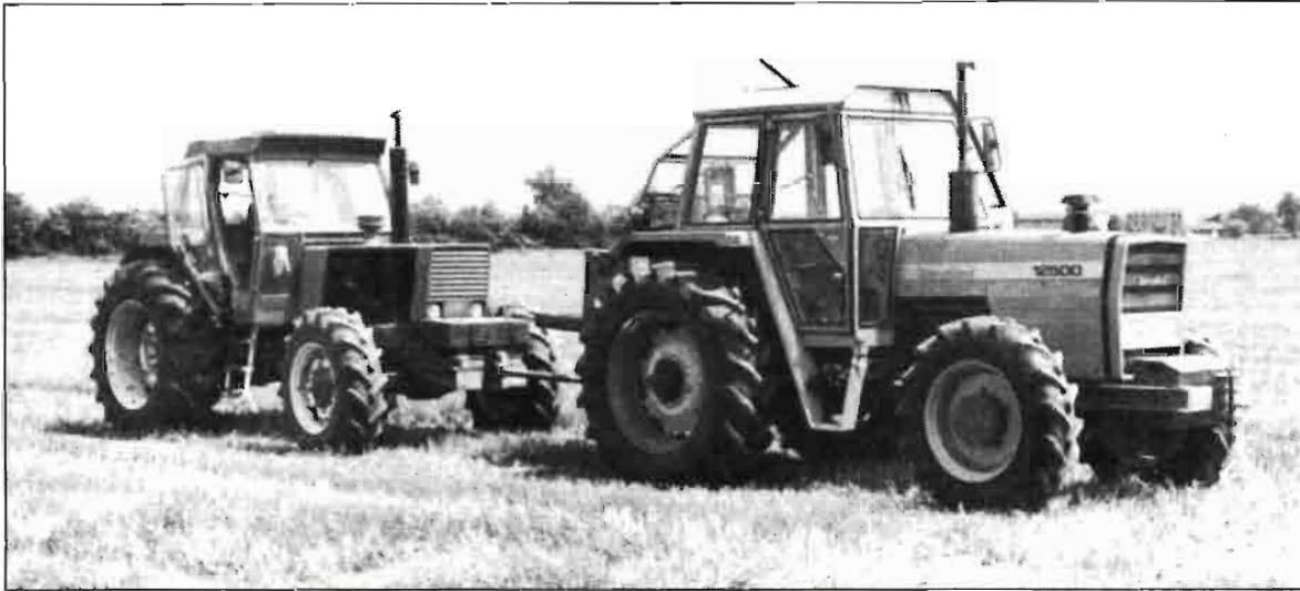
FIGURA 6. Prueba de tracción en campo para medida de las prestaciones del neumático. El tractor arrastrador sólo utiliza un eje motor (trasero) el cual se encuentra equipado con los neumáticos experimentales. El tractor arrastrado actúa como freno, y su función exclusiva es ofrecer una fuerza de tracción variable.
