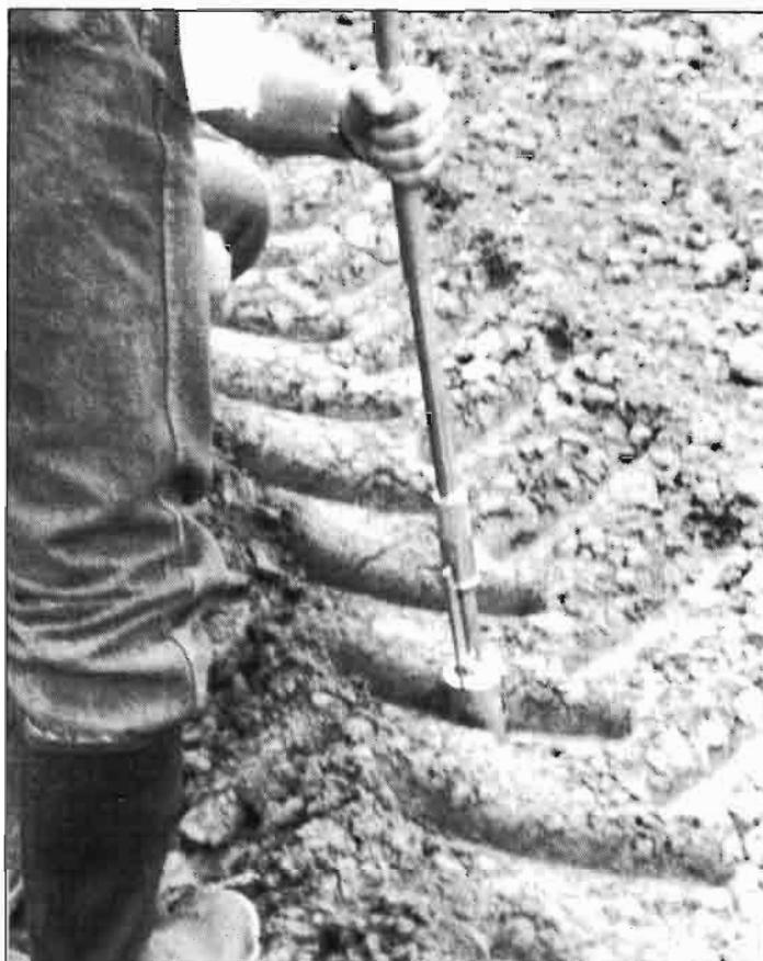
**FIGURA 10.** Dispositivo para medir la porosidad del suelo. A través de esta medida se puede tener una idea de la dificultad de penetración de las raíces en el mismo. Naturalmente, con un desarrollo radicular limitado la producción agrícola será inferior.
