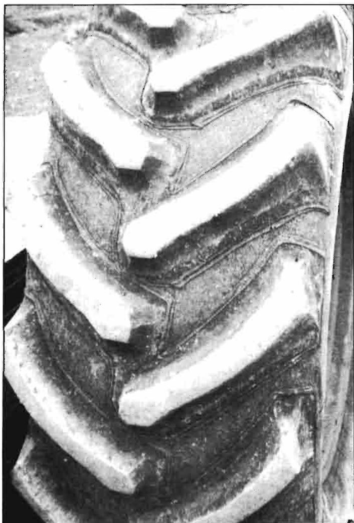
FIGURA 5. Neumático experimental (Pirelli) obtenido mediante pegado de bandas sobre un neumático liso. Con este procedimiento resulta económico probar neumáticos de diferente estructura y dimensión sin tener que construir previamente moldes costosos.
