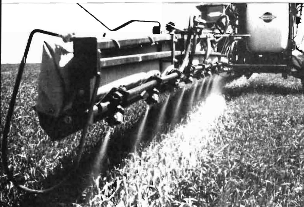
Pulverizador hidráulico Hardi Twin.
