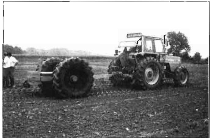
FIGURA 8. Prueba de rodadura. Los neumáticos experimentales se montan en el carro que arrastra el tractor. La relación entre la fuerza necesaria para el arrastre y el peso sobre las ruedas permite obtener el coeficiente de rodadura.
