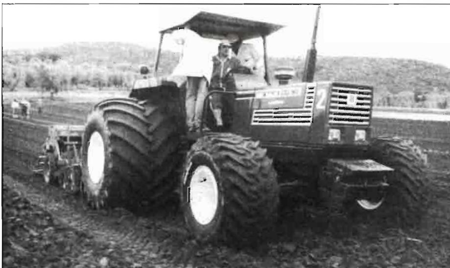
FIGURA 9. Neumático extra-ancho (Good Year) para reducir las pérdidas por rodadura en suelos blandos y la compactación del terreno.
