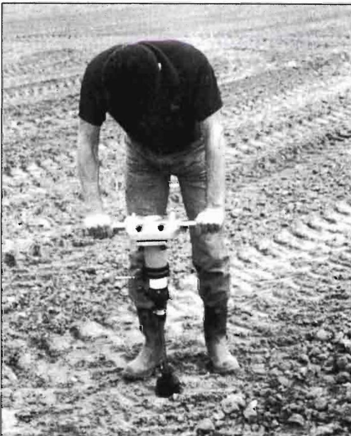
**FIGURA 11.** Medida de la compactación del terreno con el penetrómetro. La fuerza de penetración que hay que efectuar para introducir una punta cónica dividida por el área de la base proporciona un índice de la compactación.
