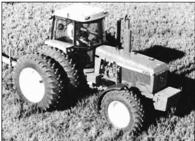
Tractor John Deere, mod. 4955, con motor de 240 CV fabricado en Waterloo (USA).
