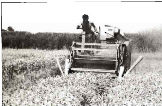
Microcosechadora, recolectando un campo de ensayos de valor agronómico de variedades de trigo en Movera (Zaragoza).
