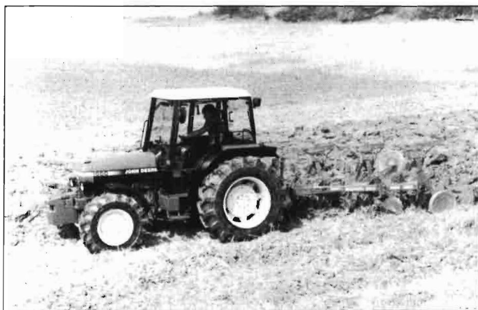
Nuevo tractor John Deere Modelo 1950, motor de 3 cilindros y turbo, 67 CV de potencia.
