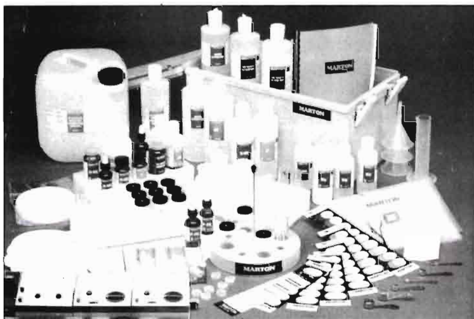
Equipo portátil de análisis de macronutrientes para suelos minerales usado por agricultores franceses e italianos.
