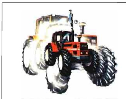
**SAME** ha aportado en los últimos años las más innovadoras soluciones: Doble tracción original, frenos a las cuatro ruedas, inversor de marchas, velocidad máxima 40 Km/hora, puesto de conducción reversible, toma de fuerza y elevador delantero y trasero. Una línea completa de 30 a 170 CV. de potencia, simple y doble tracción, fruteros, viñeros y arco alto y, además, una moderna gama de tractores oruga. SAME, tractores versátiles, rentables, de bajo consumo y al precio más competitivo.
