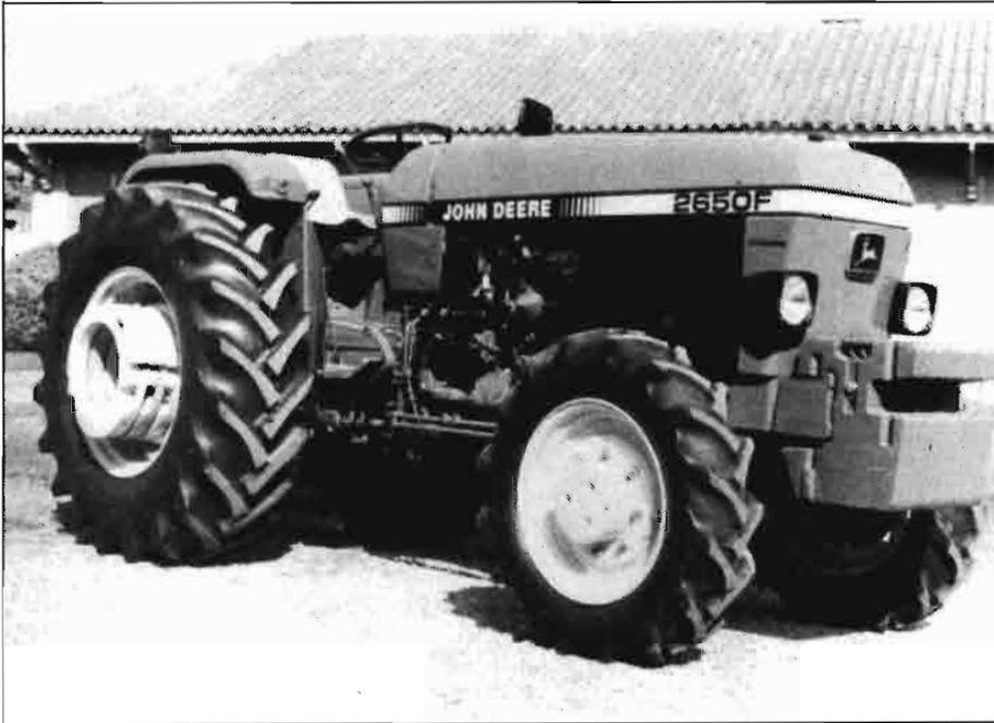
*Tractor frutero 2650F de 83 CV de potencia, 3.920 c.c. de cilindrada y doble tracción de John Deere.*
