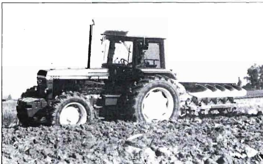
*Tractor John Deere, mod. 3.650, con 120 CV homologados, que incorpora termoventilador y otras mejoras, consiguiendo un ahorro de combustible de 0,8 litros/hora.*
