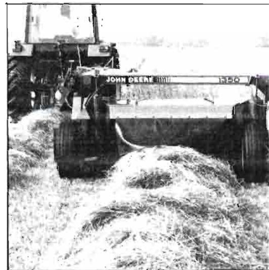
Segadora-acondicionadora de forraje John Deere, mod. 1.350, con sistema acondicionado por mayales, como la 1.360, novedades junto al modelo 1.460, de concepto distinto de acondicionado a través de rodillos.
