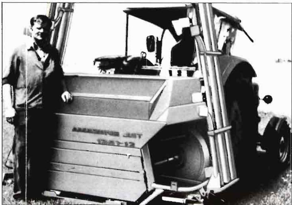
La nueva abonadora neumática Amazone Jet 802/1202 resulta extremadamente baja y puede llenarse directamente desde volquetes normales. La Jet 802/1202 de 15 m y 16 m de anchura de trabajo viene como standard con levantamiento hidráulico de las rampas (accesorio opcional para 10 y 12 m). El abonado de cobertura se realiza mediante un sencillo giro de las pantallas de choque sin elementos adicionales.
