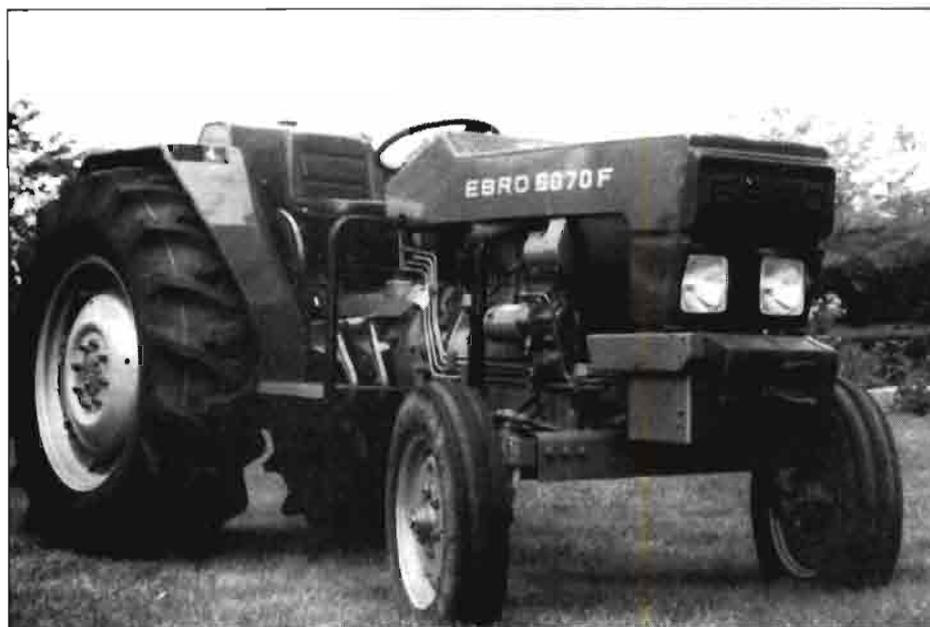
*Ebro Kubota está ya produciendo, en su factoría de Cuatro Vientos (Madrid) el nuevo tractor Ebro 670, un frutero potente y ligero, con potencia de inscripción de 67 CV, con un volante situado a sólo 1,45 metros de altura que solventa las clásicas colisiones con las ramas bajas del arbolado.*
