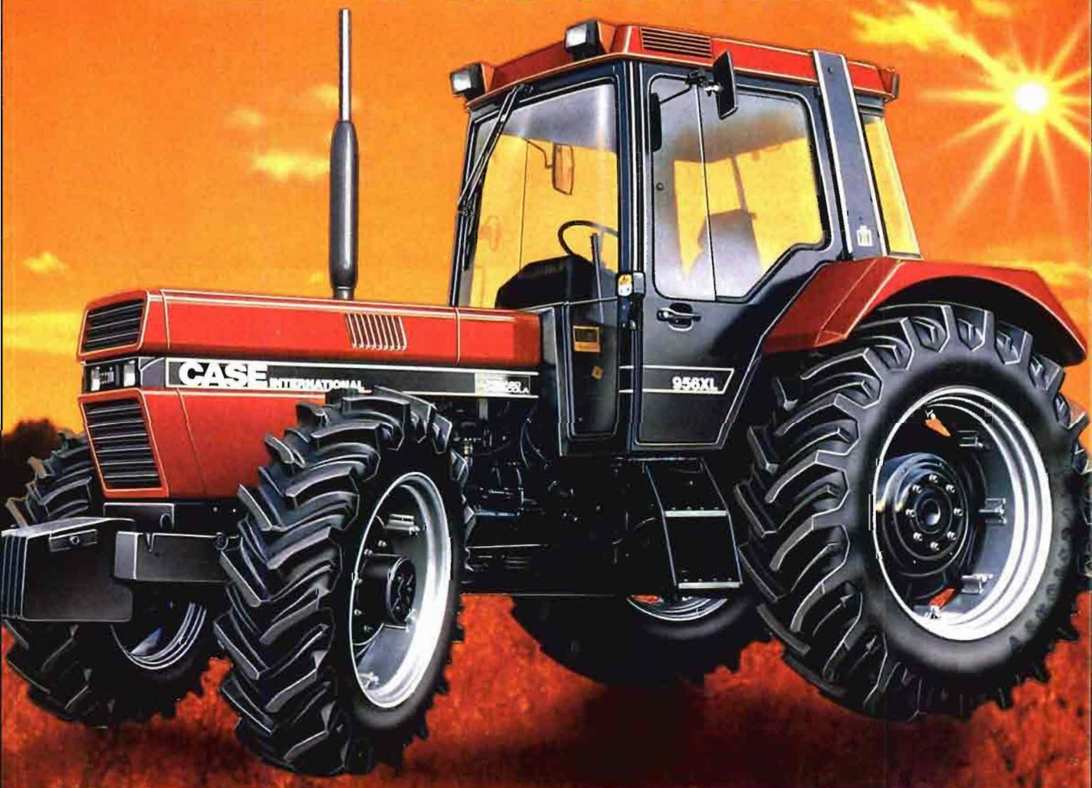
Por su nueva línea, excelente giro de ruedas (50°), menor radio de giro, mejor confort de conducción, nuevo puente de tracción delantera con transmisión central, autoblocante, mando pulsador (electrohidráulico), embrague en marcha y bajo carga,
