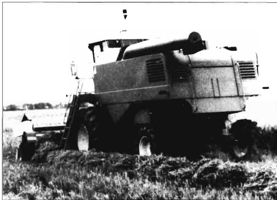
Cosechadora no convencional de cilindro transversal de FIATAGRI, medalla de Oro en SIMA '86
