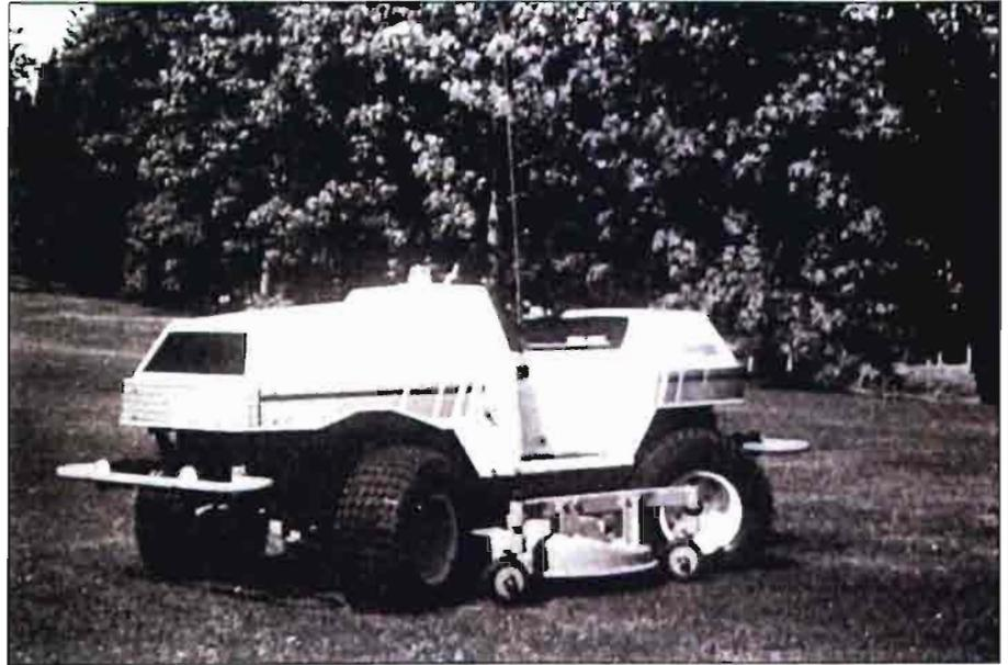
En caso de avería, de alejamiento excesivo de la caja de control o de interferencias de radio, se activa automáticamente un dispositivo de parada. También son automáticos el bloqueo del diferencial y el freno en caso de parada. El motor se detiene si se producen anomalías en la
