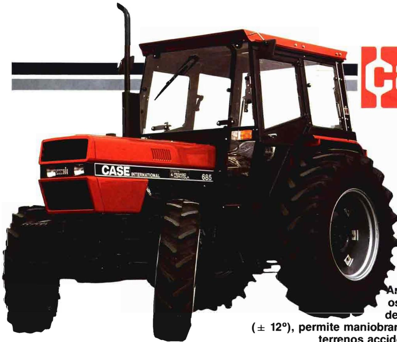
**Angulo de oscilación del puente ( $\pm 12^\circ$ ), permite maniobrar bien en terrenos accidentados.**
