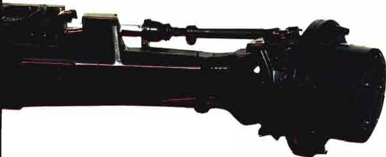
eje en el centro lleva un cojinete de apoyo o sujeción que asegura una transmisión de fuerza firme y libre de vibraciones.
