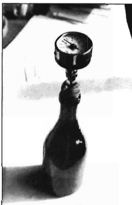
Botella con afrómetro para la medición de la presión.
