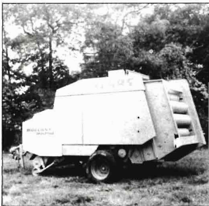
Rotoempacadora Claas que facilita la descarga de la paca sin interrupción de la marcha.
