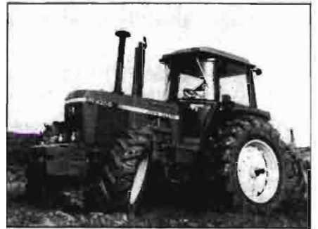
Tractor John Deere modelo 4350 de 133 CV de potencia.
