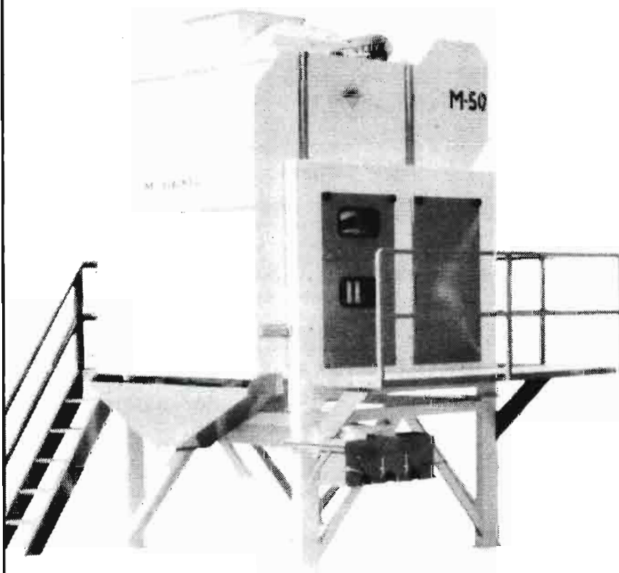
Limpiadora seleccionadora de cereales modelo M-50, muy indicada para las cooperativas cerealistas.
