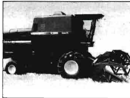
Cosechadora John Deere modelo 1085 Hydro 4, equipada con motor de 219 CV.
