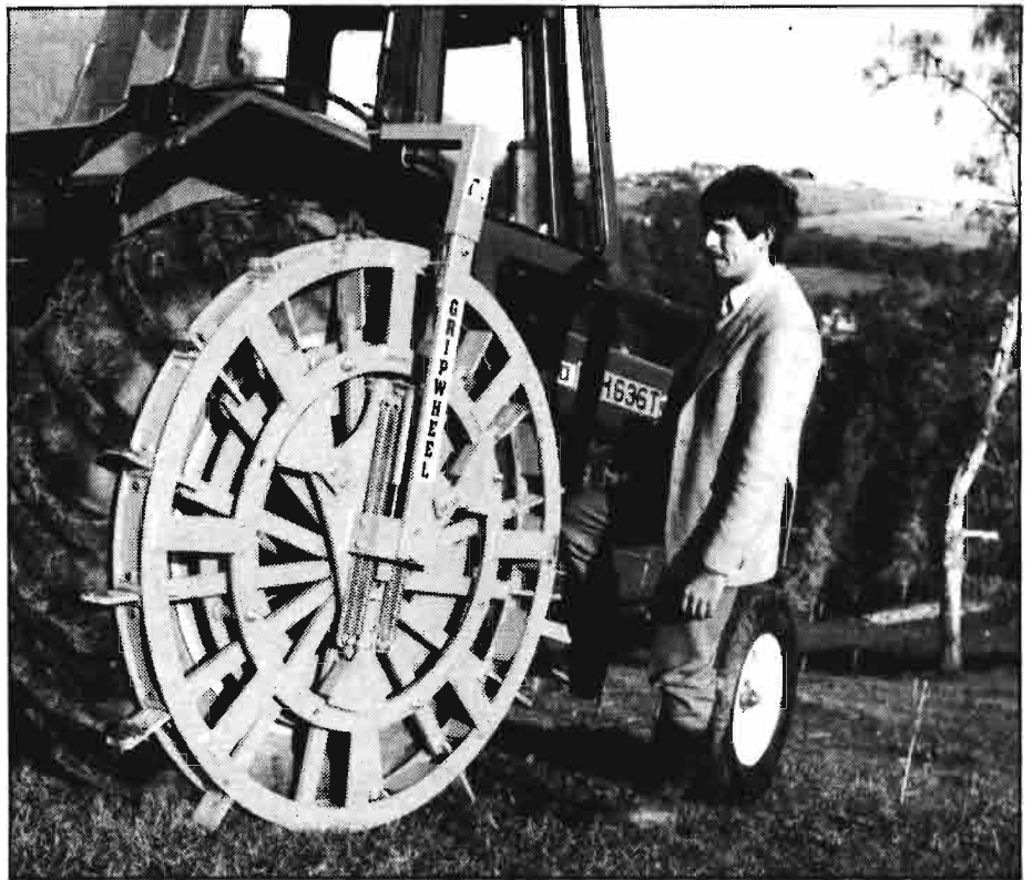
La rueda jaula montada junto a la rueda neumática disminuye la compactación del suelo cuando se trabaja con más humedad.
