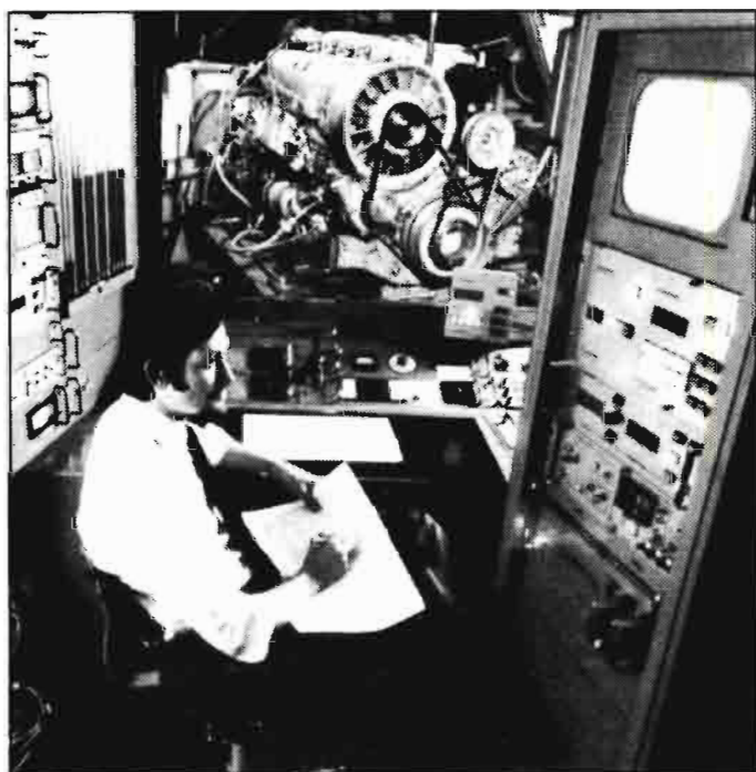
Medida de la potencia del motor. a) con el motor en banco. b) en la toma de fuerza.
