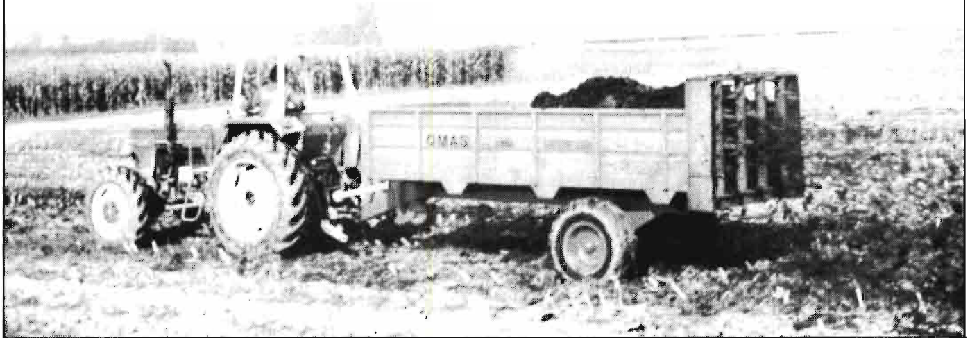
Distribuidor de estiércol de tambores verticales. Este modelo cubre más superficie que los de tambores horizontales. Es evidente la preocupación actual por el aprovechamiento y la liquidación de existencia de estiércol.
