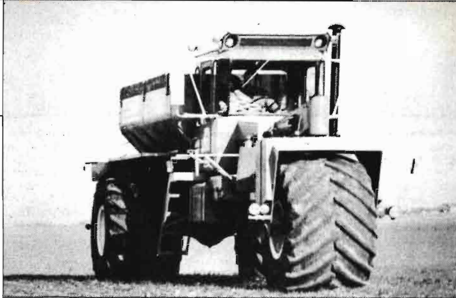
Neumáticos "terra tire" de muy baja presión.
