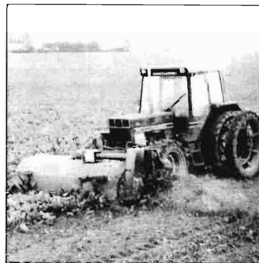
Agrupación de operaciones que convierten al tractor en una cosechadora integral.
