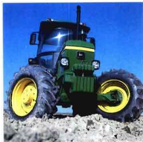
Tracción delantera con ruedas inclinables disponibles en 11 modelos de tractores de las series "Super" y "X-E" de 72 a 140 CV SAE (62 a 133 homologados).
