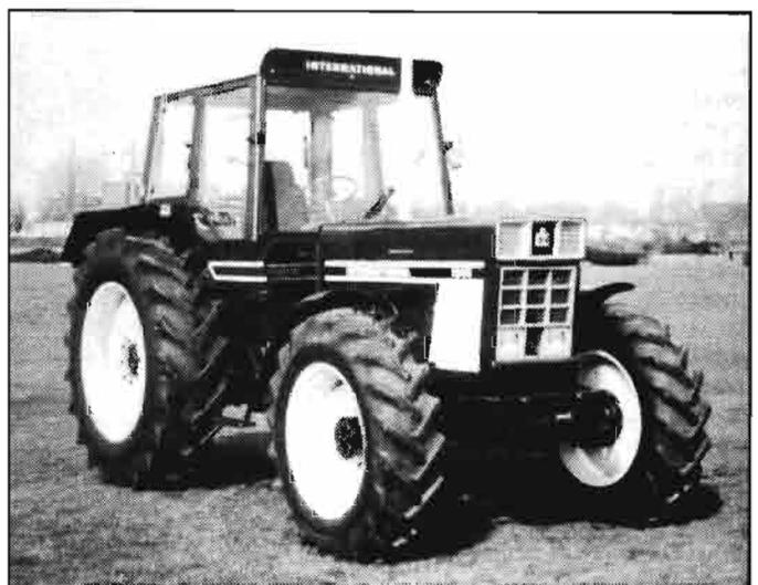
*A medida que aumenta la potencia se hace necesario el auxilio del eje delantero motor (2RM + EDM)*
