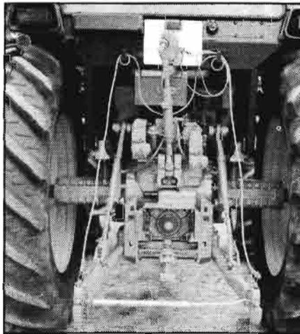
distribuidores-válvulas, que permiten con sus múltiples variantes (con o sin acumuladores de presión) dar acceso a acciones de simple o doble efecto, a gatos que actúan en las máquinas operadoras sin la utilización de mecanismos de transmisión o engranajes intermedios.
