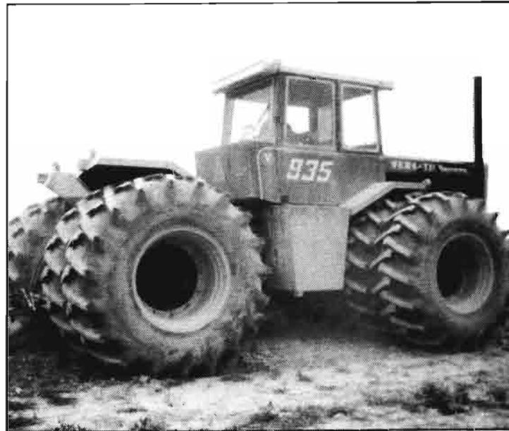
Las grandes potencias precisan una adaptación en la estructura. Ejemplo de tractor 4RM con rueda gemela.
