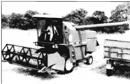
*Cosechadora John Deere 1052 equipada con motor turboalimentado de 85 CV. DIN, dotada de 4 sacapajas de 5 saltos. Puede montar plataforma de corte, de enganche rápido «Quick-Tatch», de 3,05 m, 3,65 m, o 4,25 m de ancho.*
