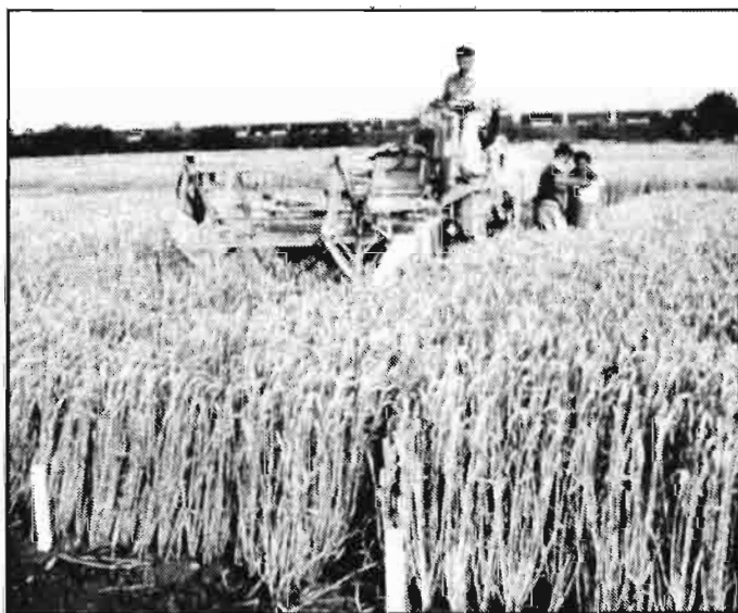
Cosechadora para parcela experimental para recolección de semillas de grano fino.
