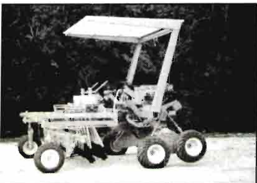
Tractor porta-apero con sembradora de chorrillo de distribución estadística de semillas.
