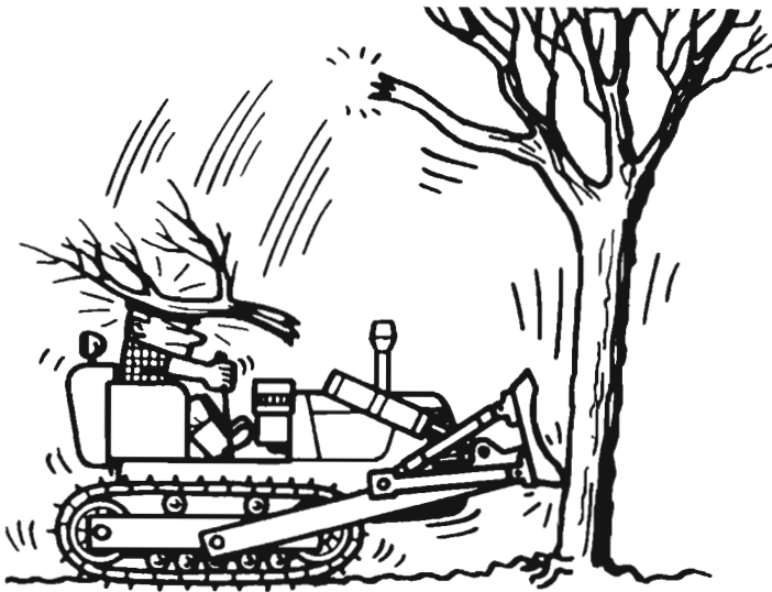
La maquinaria forestal requiere una protección especial frente a la caída de objetos sobre el conductor.
