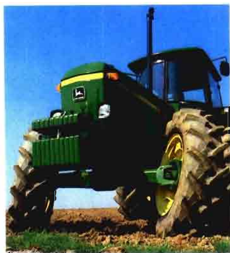
Tracción delantera con ruedas inclinables disponibles en 7 modelos de tractores de 72 a 140 CV SAE (62 a 133 homologados).
