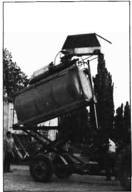
Remolque Catasús, modelo California, con la cisterna elevada e inclinada para su descarga.
