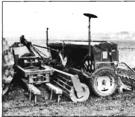
Equipo tandem SE-301 con sembradora convencional, con adaptador mecánico y rodillo de desmenuzar, para cultivos de primavera.
