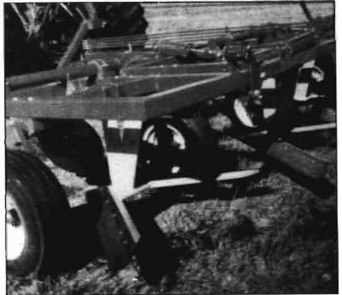
El ángulo de la reja estirpadora facilita el corte de la maleza, sin arrastre de la tierra.
