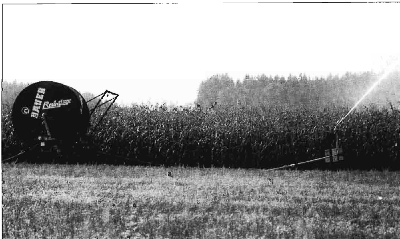
Cañón de riego y trineo de arrastre, de gran alcance, que puede utilizar el lissier de las granjas pecuarias.
