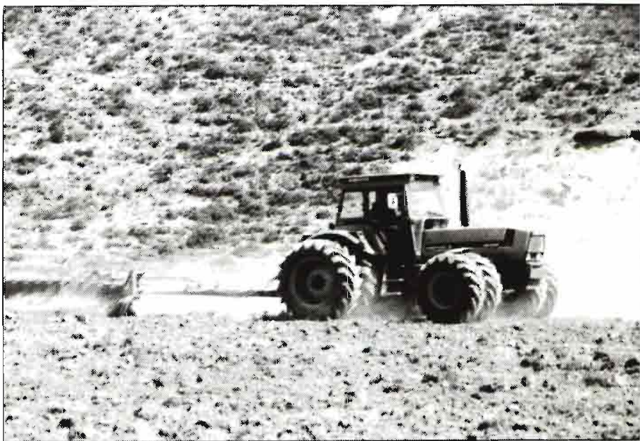
La utilización de toda la potencia del motor en labores pesadas exigen neumáticos bien dimensionados y lastre.
