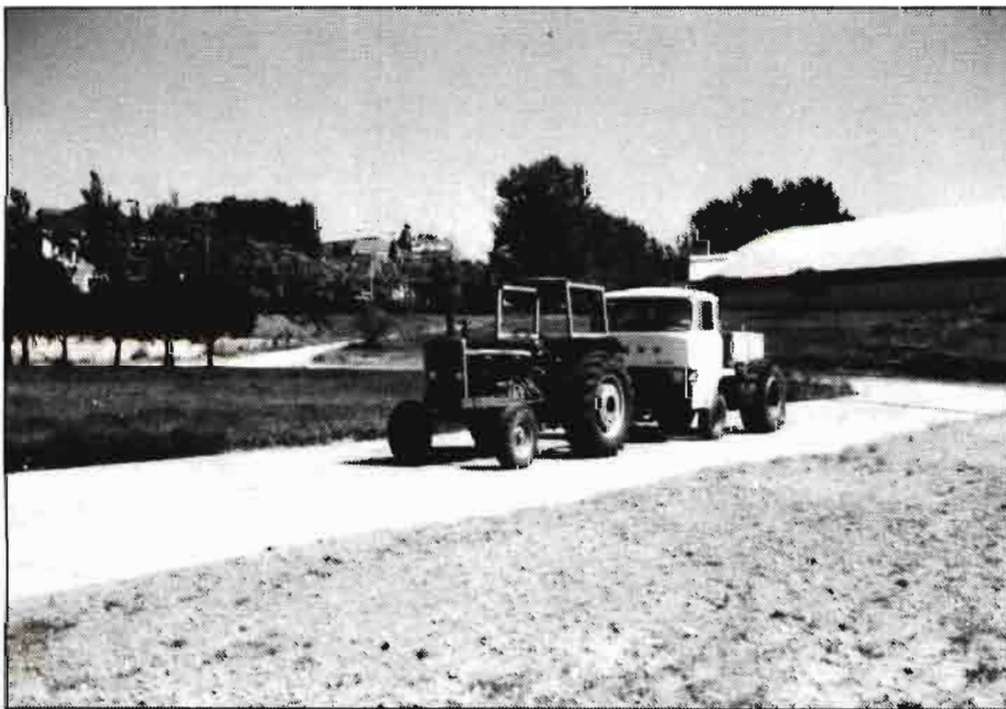
Medidas de la potencia de tracción en pista de ensayos.
